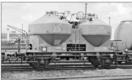
Nach denselben Zeichnungen entstand der Zks 54-54-67, aber bei Niesky. Das Foto zeigt den seit 1980 als Uc-v[9021] 902 1609 bezeichneten Wagen im September 1993 in Gera. Inzwischen wurden die Bleche vor den Wartungsöffnungen für die Ventile und Stützen nicht mehr montiert und der Wagen hatte Seilhakensolen erhalten. Foto HW
