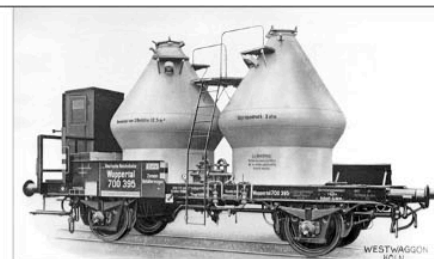
1931 lieferte Westwaggon Köln den Zementbehälterwagen Wuppertal 700 395 als Dienstgüterwagen an die DRG. Wofür diese einen Wagen mit nur 2 x 6,25 m³ Behälterinhalt verwendete, ist nicht bekannt. Werkfoto Westwaggon, Slg. SC
