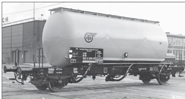
Am 15.11.66 stellte Linke-Hofmann-Busch in Salzgitter als ersten 52-m 3 -Granulatwagen der VTG den 092 0 059 [P] fertig. Das Bild entstand vor der Fertigungshalle.
