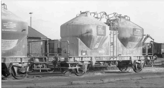
Den Uc-v[9021] 902 2222 [P] hatte die DR für den Transport von Steinmehl Gbf an den VEB Zementwerke Rudersdorf, Tagebau Mahlanlage 3 vermietet – zur Ladegutkennzeichnung trug er ein rotes M auf weißem Grund. Im Oktober 1983 stand der 1968 vom VEB Waggonbau Niesky gebaute Wagen – der letzte, für den das kurze Untergestell nachgewiesen ist – im Gbf Hamburg-Harburg. Foto SC
