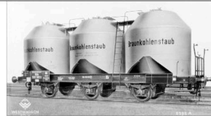
Die für die Gewerkschaft Neurath gebaute und am 4.6.34 fertiggestellte Köln 592 982 [P] erhielt bereits 57-m³-Behälter, besaß kein Bremserhaus und nur noch jeweils eine Leiter auf jeder Seite. Werkfoto VWW, Slg. HW
