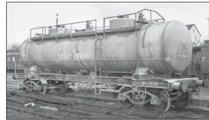
Die DB baute insgesamt 165 vom USATC übernommene vierachsige Kesselwagen zu Staubgutwagen für den Zementtransport um. Die ersten 16 erhielten nur einfache Förderdüsen, alle weiteren Auflockerungsböden. Ein solcher Serienwagen war der Kkd 49 359 052, aufgenommen im Dezember 1959 in Kassel-Wilhelmshöhe. Foto Reinhard Todt, Slg. Eisenbahnstiftung
