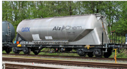
Im Juni 2015 standen bei Feldbinder fünf BEUT 73.4-3/1, vorn im Bild der Uacns 9327 991, zur Übergabe an die Wascosa bereit. Werkfoto Feldbinder Spezialfahrzeugwerke GmbH
