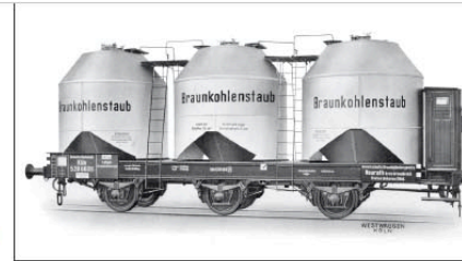
Der Köln 539 660 [P] der „Gewerkschaft d. Braunkohlenbergwerks Neurath Kreis Grevenbroich“ zeigt die klassische Form der Kohlenstaubwagen. Werkfoto Westwaggon Köln, Slg. Klaus Holl
