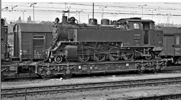
Der geschweißte 978 5502 war der einzige Lokomotivtransportwagen mit 900 mm Spurweite; er basierte auf der Krupp-Konstruktion von 1928. Am 30. August 1970 stand er beladen mit auf der Strecke Bad Doberan – Kühlungsborn eingesetzten 99 323 im Bf Dresden-Friedrichstadt.
