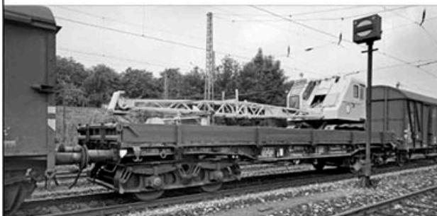
Für größere Maschinen, insbesondere Bagger mit langen Auslegern, waren vierachsige Wagen erforderlich. Das Foto zeigt den Wagen für Oberbaumaschinen und Geräte 231 971 6 247 des Gib Hamburg-Harburg. Im Mai 1975 stand er im Rbf Hamburg-Wilhelmsburg beladen mit einem Seilbagger vom Typ Weserhütte W35 Pionier. Den zuvor als Hamburg 4169 bezeichneten Wagen hatte die DB schon 1958 aus dem SSKm 49 973 240 umgebaut und mit Steckborden versehen, 1976 wurde er ausgemustert. Fotos Benno Wiesmüller
