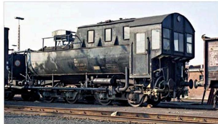
Der im September 1977 in Hamburg-Wilhelmsburg fotografierte Sprengwagen 924 973 5 065 des GI Hmb-Harburg wurde aus einem Wannentender hergerichtet. Unter der kurzen überkragenden Bedienkanzel saßen Spritzrohre, mit denen sogar Bahnsteige beregnet werden konnten. Der ehemalige Kohlenkasten wurde zu einem großzügig bemessenen Pumpenraum mit seitlichen Fenstern umfunktioniert. Fotos Benno Wiesmüller
