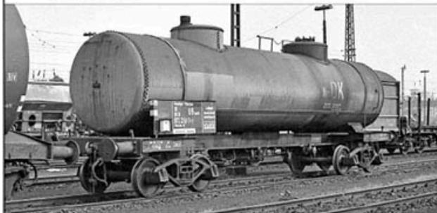
art übernehmen, bei denen die DB die zu Anrissen neigenden keilförmigen Kopfstücke und die Drehgestelle verstärkte. Selbst Wagen, die ursprünglich für den Transport von Masut – einem in Russland produzierten zähflüssigen schwerem Heizöl – mit Isolierung auch des Doms gebaut worden waren, kamen zur DB.
