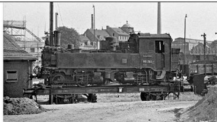
Am 4. August 1963 stand 99 586 auf dem Wagen für Schmalspurfahrzeuge 84-31-34 in Freiberg. Damals waren die Wagen bis auf die Hülsenpuffer noch unverändert – die Flacheisen-Achshalter und die Radsätze mit Länderbahn-Gleitlagern entsprachen noch dem Ableferungszustand.
