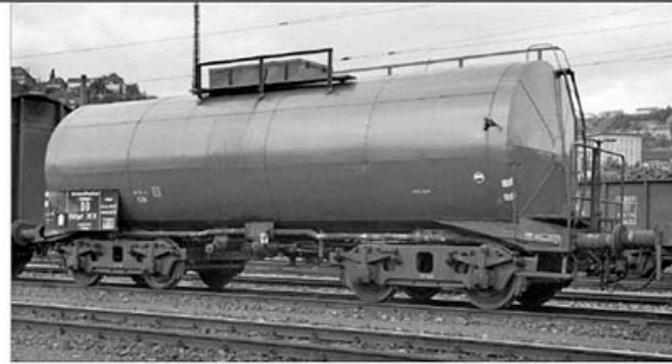
Die Ausstattung des 1959 in Stuttgart Hgb fotografierten Kesselwagens Stuttgart 3800 war ungewöhnlich. Der 48-m<sup>3</sup>-Kesselwagen Deutzer Bauart erhielt nicht nur eine Kesselsolisierung, sondern auch eine Einhausung von Dom und Ventilschindel. Obendrein besaß er eine Dampfheizleitung, sodass das Ladegut auch während der Fahrt warm gehalten werden konnte.
