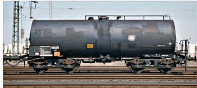
Der vermutlich im Sommer 1971 in Trier fotografierte „BD Saarbrücken 972 3 166“ war zum Zeitpunkt der Aufnahme bereits Reservewagen des BZA München. Der 48-m<sup>3</sup>-Kesselwagen Deutzer Bauart besaß keine Isolierung, dafür aber zusätzliche Rohrleitungen und Schläuchen, vermutlich zum Betanken von Ölheizungen. Foto Philipp Schreiber
