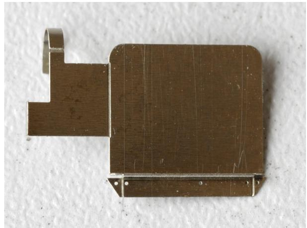
Als nächstes wird die kleine Blechlasche aufgestellt, die später zum Anlöten des 0,4 mm-Haltdrahtes dient.
